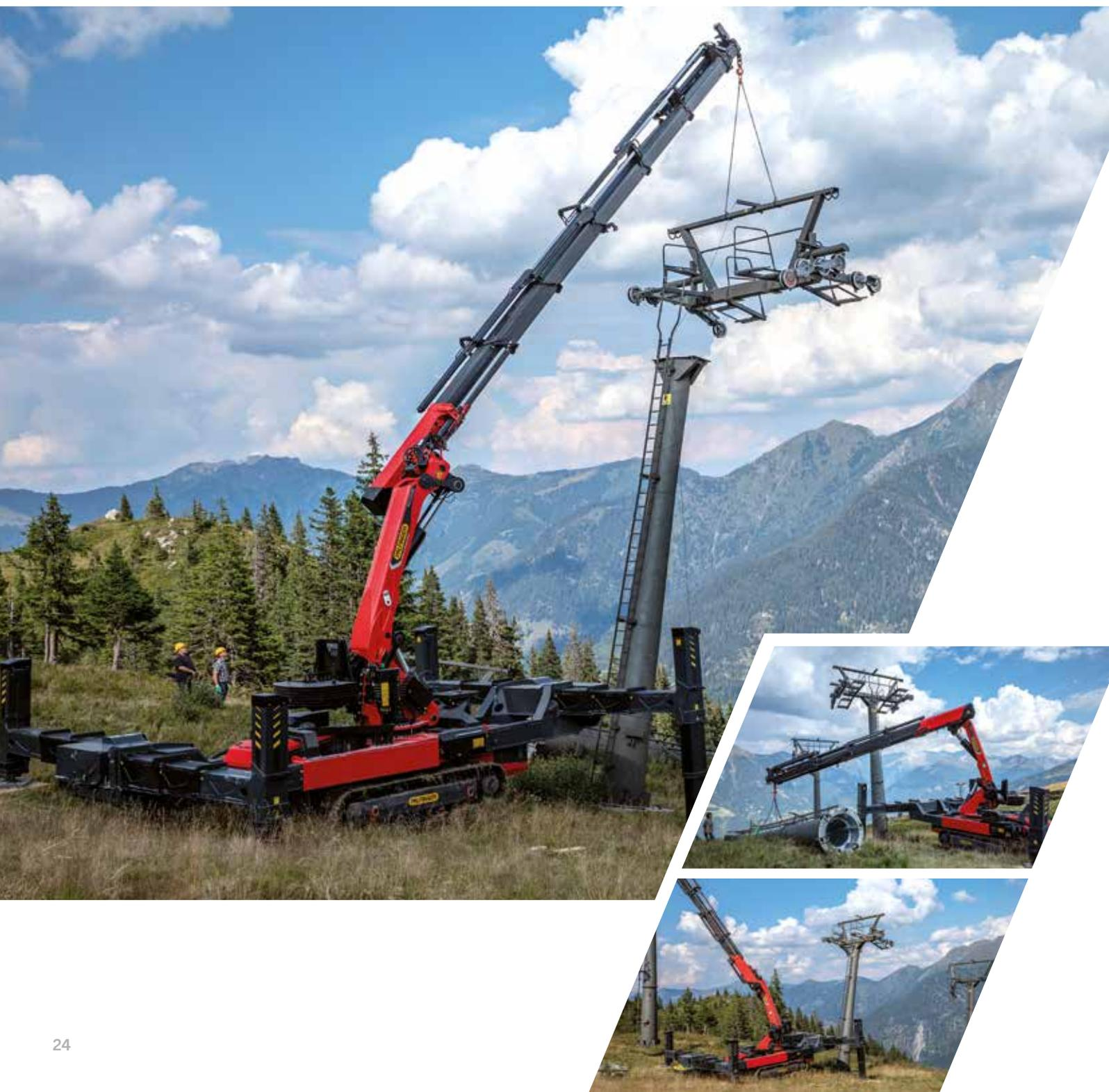
**Praxistest: Beim Abbau von Liftstützen im Gasteinertal konnte der PALFINGER Crawler Crane PCC 115.002 seine Stärken in schwierigstem Gelände unter Beweis stellen.**
